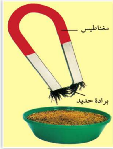
شكل (٣٦): يتم فصل بعض المواد الصلبة المصنوعة من الحديد عن طريق الجذب المغناطيسي.
